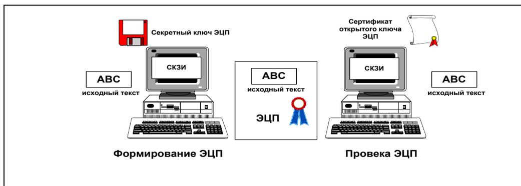
**Рисунок 2. Формирование и проверка ЭП**
