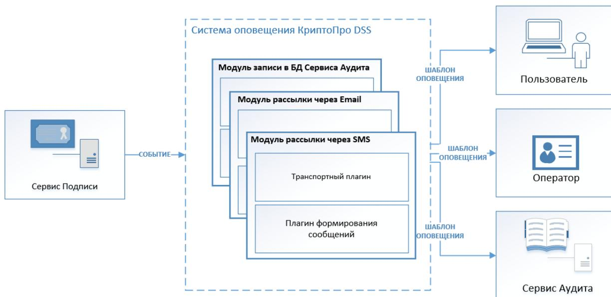
Рис. 31 — Схема работы системы оповещения
